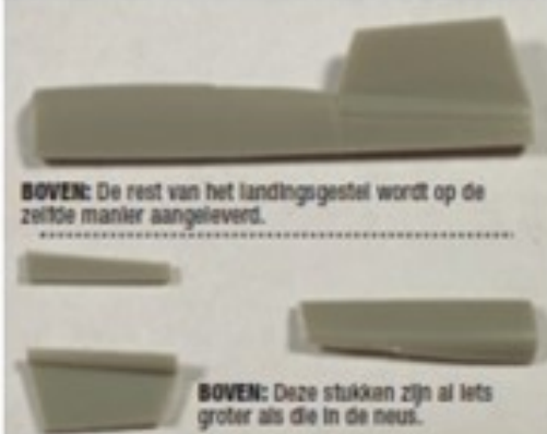
ONDER: Voor wat Revel klaar weet te boxen qua details in 1/144 slaan ze in deze onderdelen wel de plank mis. Alles is eigenlijk te dik en laat zich opengevoerd moeilijk op de juiste manier plaatsen.
