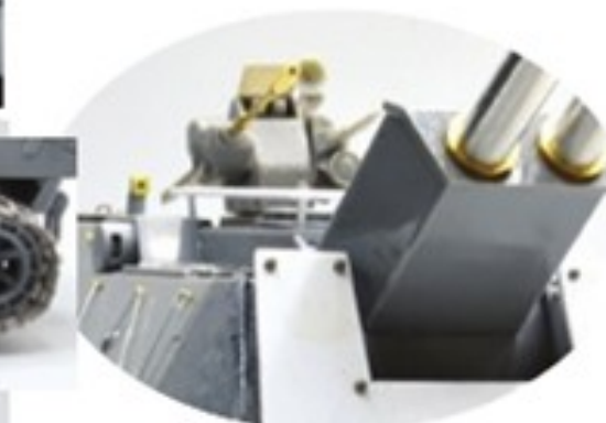
LINKS: Het zware gewicht van de tank heb ik gesimuleerd door verschillende balanceergewichten in de koepel aan te brengen waardoor de kunststof vering van de ophanging zeer realistisch wordt ingedrukt.
