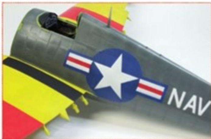
BOVEN: Zoals al eerder vermeld moeten de markeringen op de romp voorzichtig uitgelijnd worden, niet alleen ten opzichte van zichzelf, maar ook in verhouding tot elke andere. Absolute concentratie is nu vereist gedurende deze schildertase. Veel maskeertape werd hiervoor gebruikt en ook herhaalde opmetingen en correcties waren nodig, voordat de maskeringen op de goede plek zaten.
