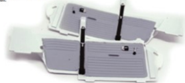
BOVEN: De deurpanelen en het dashboard werden tezamen met de body gespoten in de kleur 'Porsche Pure White' en afgelakt. De deurpanelen werden daarna gedeeltelijk terug in de primerkleur gespoten. Details als veiligheidsriemen, raamhendels en deuropeners werden opeenvolgend gemonteerd.
