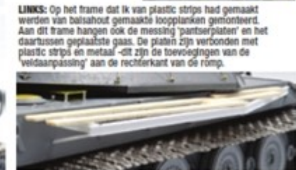
BOVEN: Hier heb je goed zicht op het 'gelaste' draagframe dat gemaakt is van Evergreen plastic strips. Het frame loopt aan de voorkant schuin weg. Daarbovenop zijn loopplanken gemonteerd voor de bemanning.
