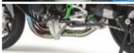
BOVEN: De uitlaat werd eerst gespoten met Gloss Black. De Alclad 'hotmetal' serie van verven zorgen voor de verkleuringen.
