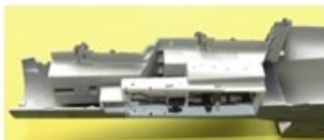
BOVEN: De motorruimte is hier in het rompedeel aangebracht (van onderzijde gezien).
